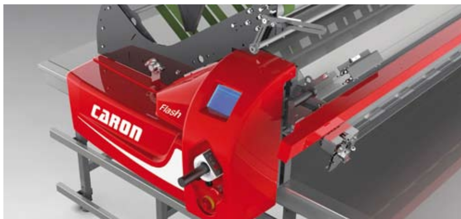
Dzięki fotokomórkom automatycznie rozpoznawane są krawędzie materiału i koniec belki, co odpowiada za równe układanie rozwijanego materiału na stole. FOT. SAMEX
