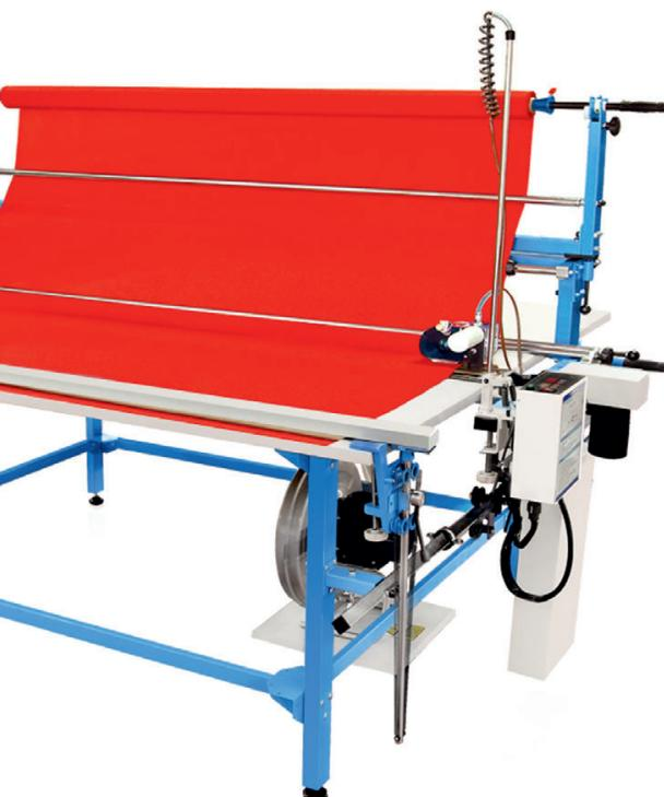
cja połączona z lekką formą stelaża nożnego, wykonanego ze stalowych profili. Dodatkowym atutem jest możliwość regulacji wysokości stołu. Blat stołu krojczego posiada utwardzoną powierzchnię oraz obramowanie mocną taśmą PVC, która zabezpiecza brzegi stołu i jest przyjazna w obsłudze.
